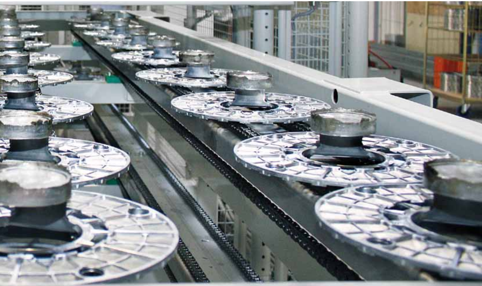
Kühlförderband mit gegossenen Filtern.
