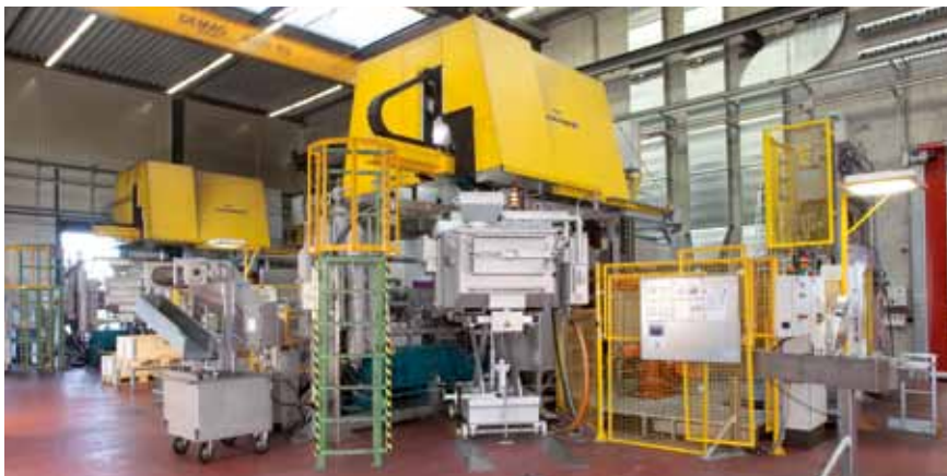
Vollautomatische Giesszellen mit Bühler Evolution 66 compact
