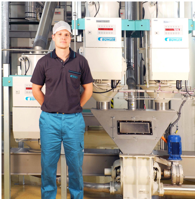
Instalación de básculas de Bühler
