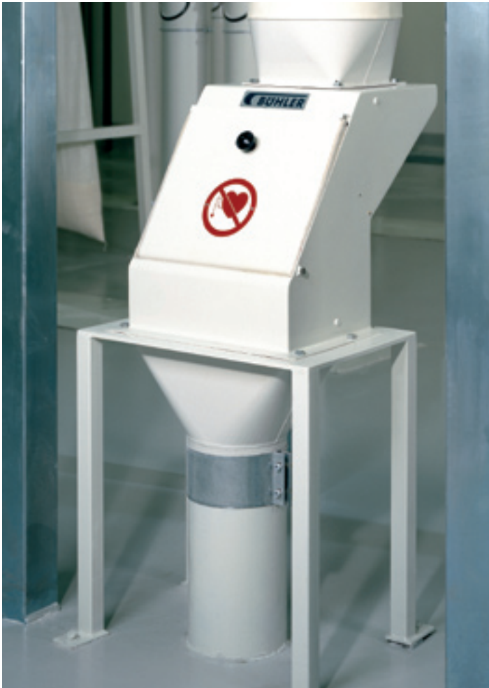
Magnetapparat MMUA. Zum Auslesen von Eisenteilen.
