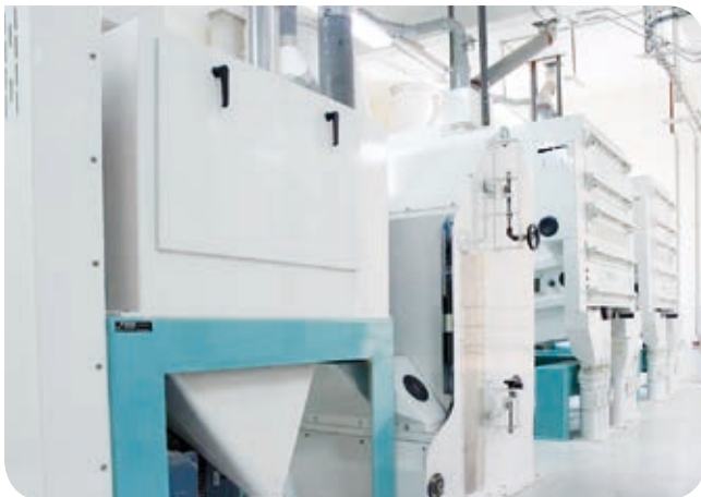
Ausgezeichneter Scheuereffekt: Scheuermaschine MHXS mit Umlufttarar MVSQ.
