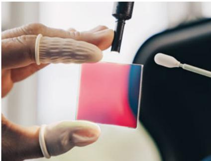
Optische Dünnschichtfilter werden hergestellt, indem dünne Materialschichten mit besonderen optischen Eigenschaften auf ein Substrat, zum Beispiel optisches Glas, aufgebracht werden.
