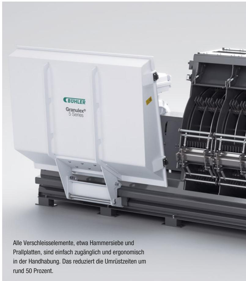
Alle Verschleisselemente, etwa Hammersiebe und Prallplatten, sind einfach zugänglich und ergonomisch in der Handhabung. Das reduziert die Umrüstzeiten um rund 50 Prozent.
