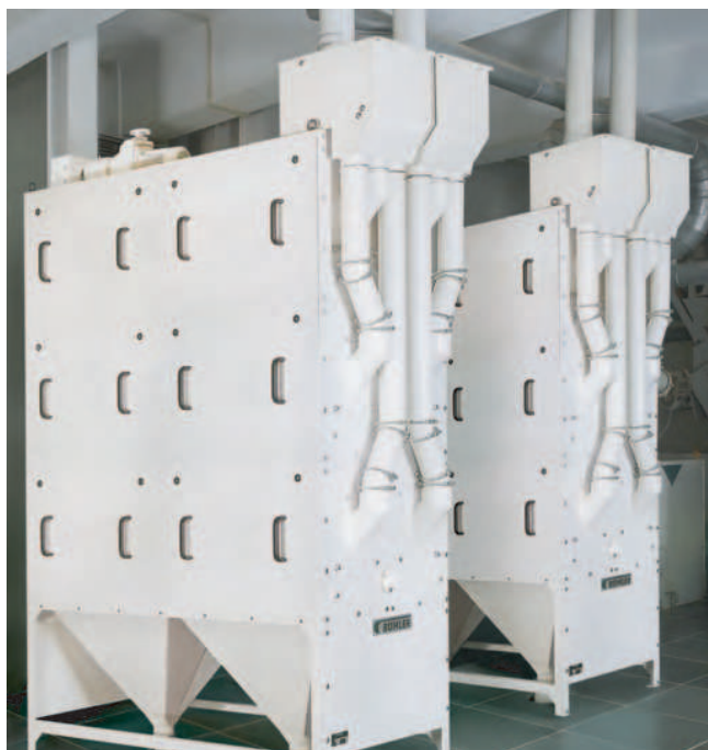
两台厚度分级机在一个大型米厂并联使用——DRGA 3D 型厚度分级机
