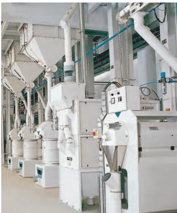
厚度分级机在米厂的紧凑型安装示范
